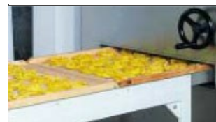
Détail nids à l'entrée du pré-sécheur
