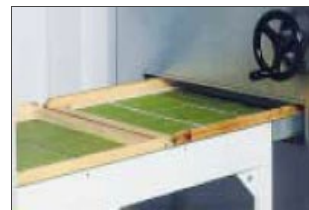
Détail lasagnes à l'entrée du pré-sécheur
