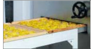
Particolare nidi all'ingresso del pre-essiccatore
