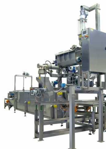
Aplicación prensa para pasta corta en línea platos pronti
