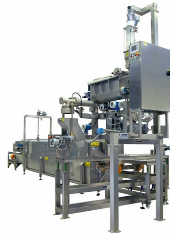
Applicazione pressa per paste corte su linea piatti pronti
