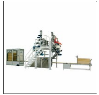
Configurazione 130.1.350 TV/C per paste corte (nidi e lasagne)
