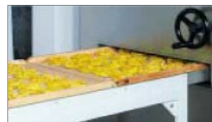
Détails nids à l'entrée du pré-sécheur
