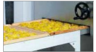
Particolare nidi all'ingresso del pre-essiccatore
