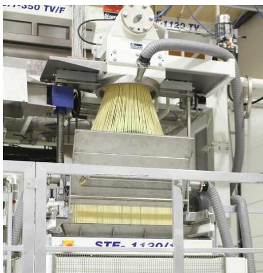
Applicazione STE 1120 su linea Omnia con spanditore a "fungo"
