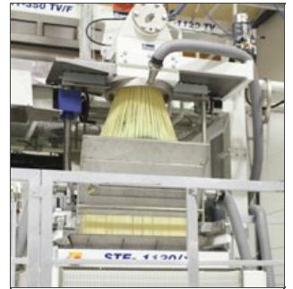
Aplicación práctica STE 1120 en línea Omnia con spanditore a "fungo"
