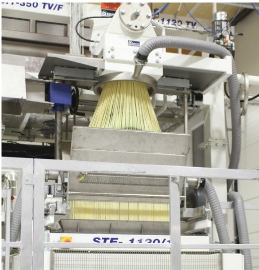
Aplicación práctica STE 1120 en línea Omnia con cono separador para cabezal circular
