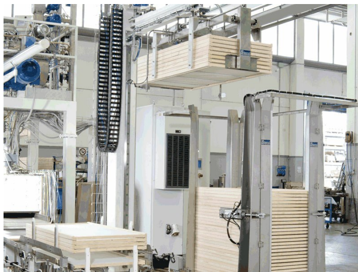
■ Robo XI: système robotisé de fin de ligne
