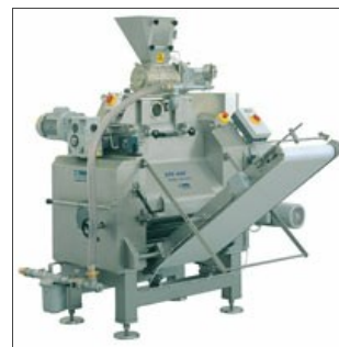
STF TV avec convoyeur d'alimentation machine à raviolis
