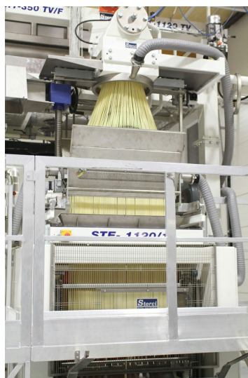
Application STE 1120 sur ligne Omnia avec cône de distribution à "champignon"
